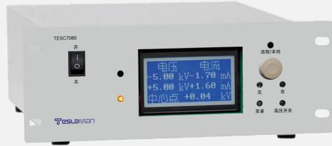
泰思曼 TESC7080 系列高压电源专为静电卡盘的应用而设计，能够在 10ms 内输出精确的电压，并在 1s 内切换极性，从而为半导体制程过程提供保护。它具有可逆的对地参考输出极性，也可以输出浮地双极电压，并有相应的浮地接口。它还有完善的故障诊断和状态监测功能，可以将数据传送到用户界面。它的封装设计紧凑轻便，可 OEM。
