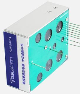
泰思曼 TMPS6064 系列是一款 7.5W 高压直流电源，模块式结构，最高输出电压可达 2.5kV，最高输出电流为 3mA。具有低噪声、高效率、紧凑的封装、低纹波和高稳定性等特点。采用 PCB 表面贴装工艺，DIP 直插方式安装，金属外壳灌封封装，输出正负单极性。
