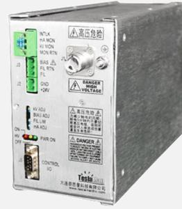
泰思曼 TXR1110 系列高压电源是 X 光机专用电源，它集成了输出直流电压 5.5V，电流 0.3A 到 3.5A 可调的灯丝电源。高压和灯丝电流可实现线性平稳上升。另具备偏置电源可使 X 光更好的聚焦，使成像更清晰。TXR1110 系列电源还可外接电位器实现输出电压和电流的远程控制，并且具有外接电压和电流显示、高压输出端过压和短路保护、安全互锁等功能。
